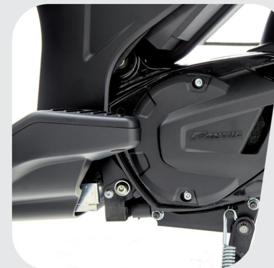
Il motore è fissato al telaio a traliccio in alluminio, questo consente di abbattere le masse non sospese per il massimo comfort e piacevolezza di guida.
